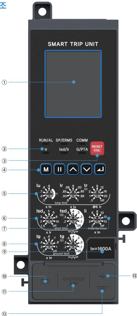
① Segment LCD: 계측 및 설정 정보 등을 표시
